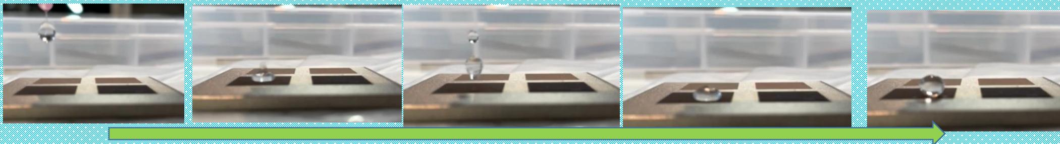
※LSA処理は、開発段階の表面処理となります。ライフサイエンス向け実績では、例えば、生化学分析装置に搭載される攪拌シャフト(Ti、SUS)表面へ施工を検討しております。超撥水表面へ変化させ、シャフト表面の水分残渣を無くすことで、性能結果向上を目指しております。
